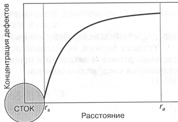
Рис 2.26. Схема концентрационного профиля мобильного дефекта у сферического стока
