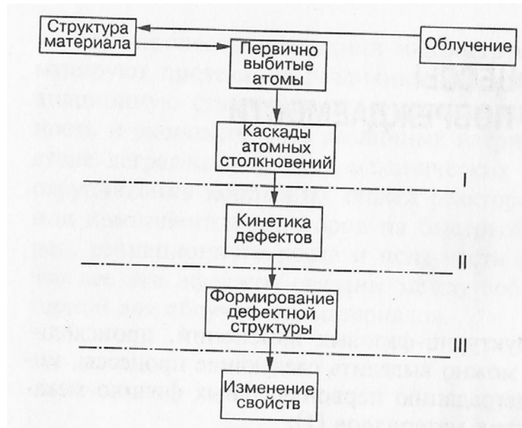
Рис. 1.1. Схема основных стадий радиационной повреждаемости материалов: I – динамическая стадия; II – диффузионная стадия; III – стадия эволюции стоков
