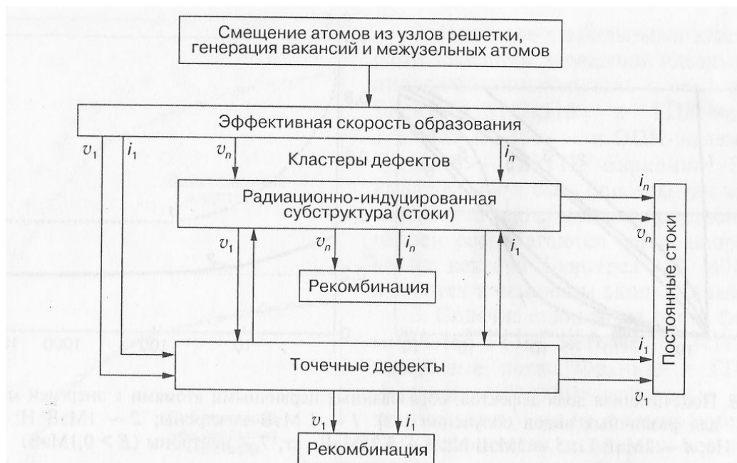
Рис 2.8. Схема эволюции каскада повреждений при высоких температурах
