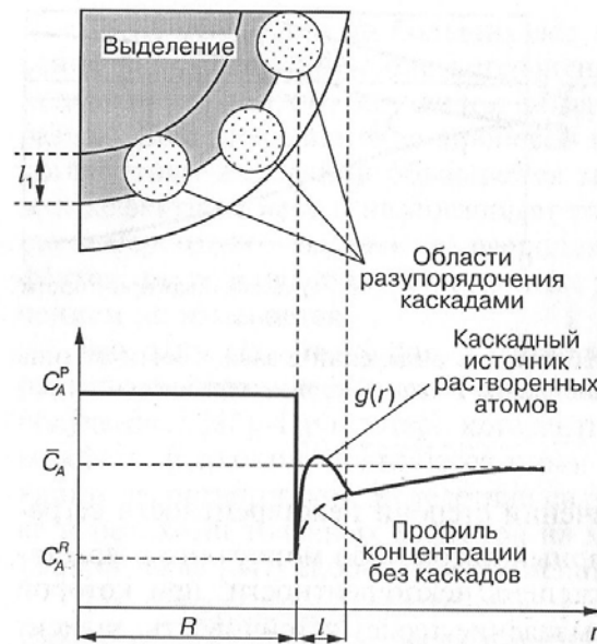
Рис. 3.14. Схема каскадно-индуцированного растворения сферического выделения
